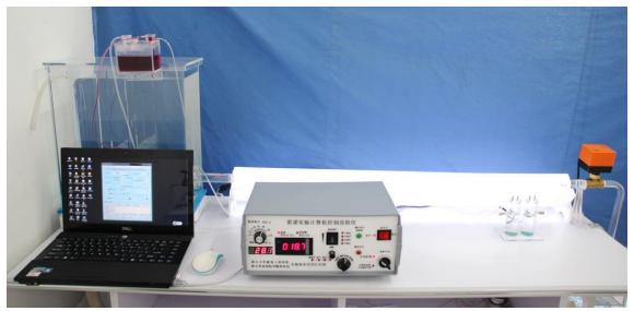
(4)自循环明渠实验槽主要功能:能为10多项明渠实验提供教学实验平台。训练明渠流稳水系统设计、流量测量、水位测量、水位测针应用、水力模型试验等技能;满足以下定性分析实验:薄壁堰、WES 曲线型实用堰、有坎宽顶堰、无坎宽顶堰和戽流的堰型和流态演示。满足以下定量测量实验:圆角进口和直角进口无侧收缩宽顶堰、WES 曲线型实用堰流量因数测量实验;水跃实验;消能 池实验;消能坎实验:挑流消能实验和闸下出流实验。
