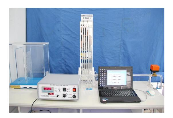
(3) 计算机控制型雷诺实验仪: 手动自动一体机。实验值流量与雷诺数电测巡检数显与手测功能并存,实验内容多功能,可提供手测、巡检仪电测和计算机实验实训软件测控 3 种实验方式; 有色水电动供水、电动加浓及实验结束时对有色水供水的软管、注射针等系统自动排水保洁功能; 电控测压筒液位控制功能; 结束时自动排除稳压筒及连接管系统中残留的水体,避免青苔污染,实现保洁功能; 实验方法、步骤全过程由上位计算机全交互式实现实体电动测控实验; 定量测量实验——测定上临界与下临界雷诺数,结果符合: Re 下临=2000—2300; 定性分析实验——观察层流与湍流(紊流)两种流态;设计性实验——结合量纲分析法进行实验研究,用管道实验测定明渠下临界广义雷诺数;虚拟仿真实验——实现基于Web以人机对话方式虚拟仿真定量量测及相关定性分析实验的功能。
