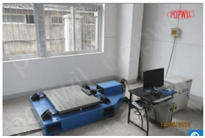
(4) 50 吨电液伺服加载系统:主要用于学生的教学实验,可以进行建筑结构(如梁、柱、墙、框架等)的压缩、弯曲等性能试验,也可以组合起来进行特殊多点加载试验。可以完成柱、梁、墙、框架以及楼板等结构件的自动控制加载、保载以及卸载等常规结构力学试验。
